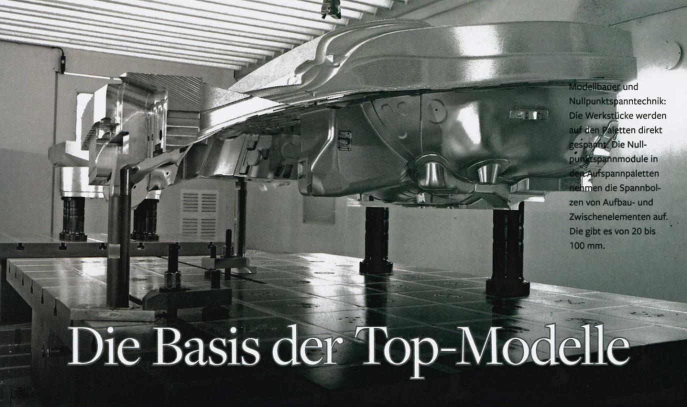
Modellbauer und Nullpunktspanntechnik: Die Werkstücke werden auf den Paletten direkt gespannt. Die Nullpunktspannmodule in den Aufspannplatten nehmen die Spannbolzen von Aufbau- und Zwischenelementen auf. Die gibt es von 20 bis 100 mm.
